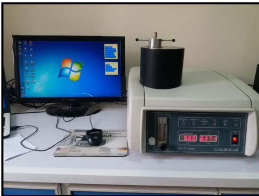
الشكل (14-3): صورة جهاز فحص (DSC).
