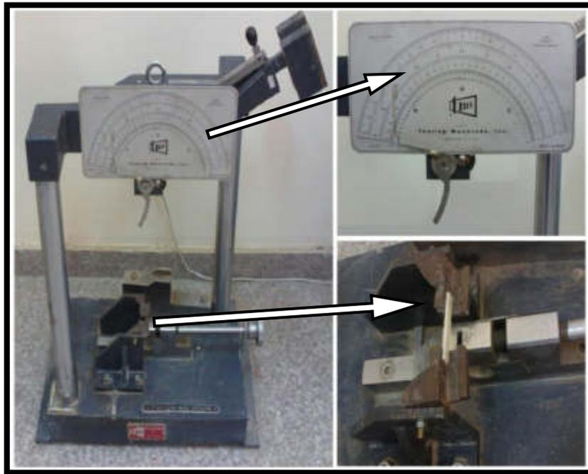
الشكل (3-10): صورة جهاز اختبار متانة الصدمة.
