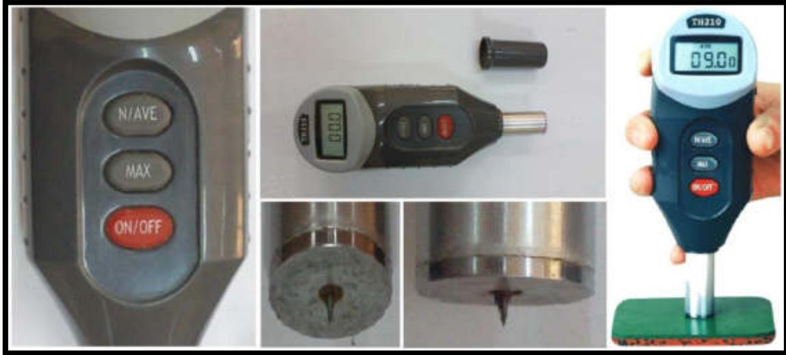
الشكل (11-3): صورة جهاز اختبار صلادة شور (D).
